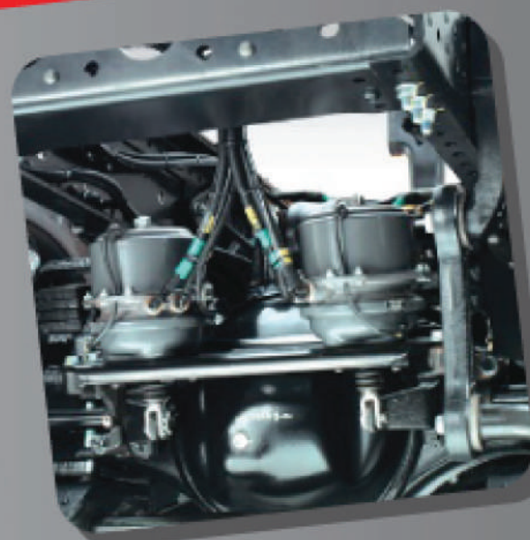
ระบบกันสะเทือน แบบพาราโบลาและโช๊คอัพ 2 จังหวะพร้อมเหล็กกันโคลง
