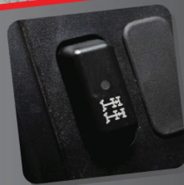
ระบบเลือกเฟืองท้าย ด้วยระบบฟูลติฟลักซ์ ช่วยส่งกำลังขับเคลื่อนขณะล้อยึดหล่ม
